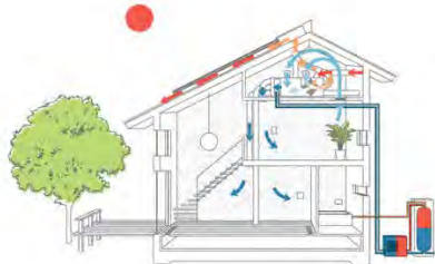
ヒートポンプ冷房と廃熱利用給湯
