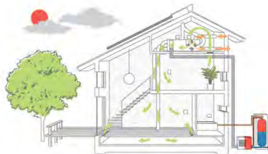
熱交換換気のみ
